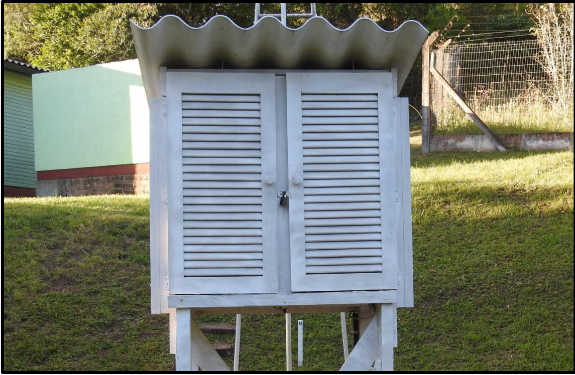
Fig. 4 - Vista frontal externa do abrigo meteorológico.
