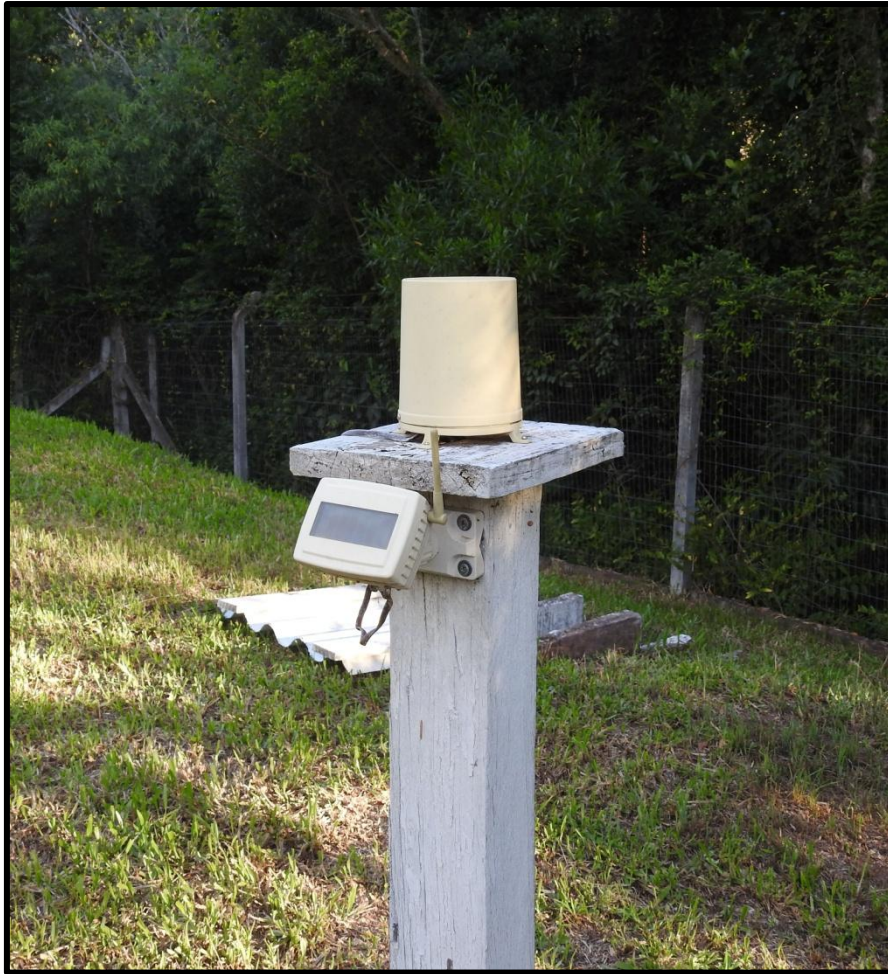
Fig. 9 - Pluviógrafo digital Oregon com unidade transmissora de rádio alimentada por energia solar.
